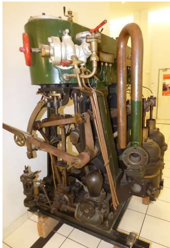
La machine à double expansion du Léchalas exposée dans le hall de la Maison des Hommes et des Techniques à Nantes (photos AF) Sur la photo du bas le grand levier sert à inverser la marche du navire en faisant fonctionner la machine à l'envers (renverser la vapeur).
