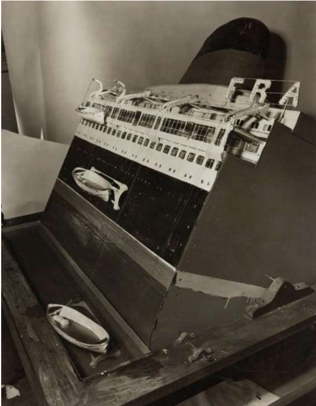
Système de mise à l'eau des canots de sauvetage breveté par Marin Marie (cliché oneartyminute)
